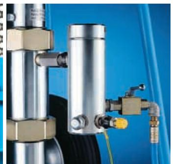
Высоконапорный фильтр на выходе насоса.
