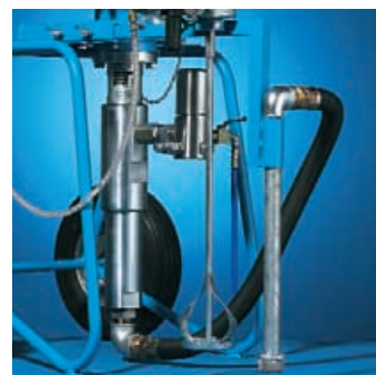
Пневмомешалка и шланг всасывания точно смонтированы с учётом их применения.
