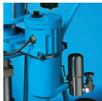
Проточный нагреватель подогревает материал просто и быстро.
